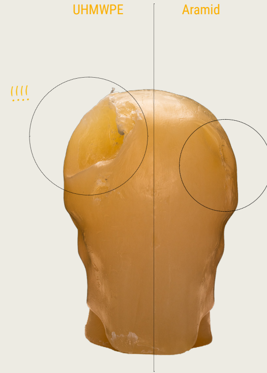
Abb. 6: Seifenkopf mit sichtbarem Trauma infolge der Verformung der Helminnenseite
